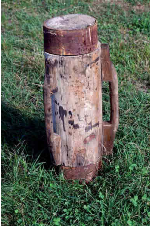
Battipalo, utensile per conficcare pali di legno nel terreno
